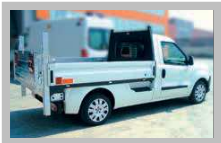
Le hayon permet le chargement des marchandises à l'arrière du caisson
